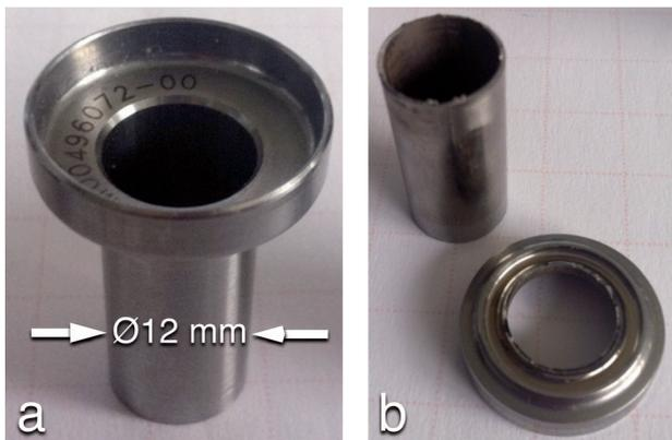
Fig. 1 - a) Original 12 mm Piston. b) Broken Piston
