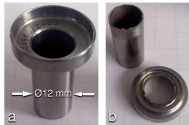
Figure 1 - a) Original 12 mm Piston. b) Broken Piston
