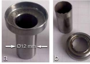
Figure 1 - a) Original 12 mm Piston. b) Broken Piston
